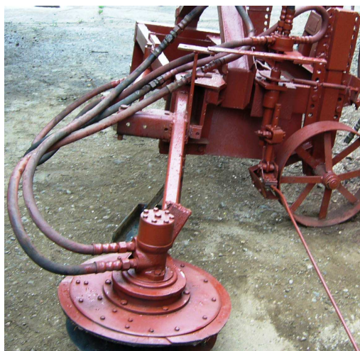
Рис. б. Фрезерний робочий орган для міжкущового ґрунтообробітку виноградників.
