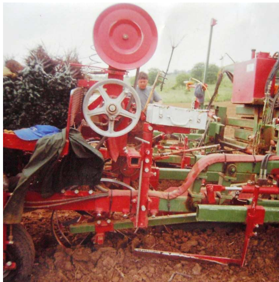
Рис. 3. Машина для садіння винограду без подачі води.
