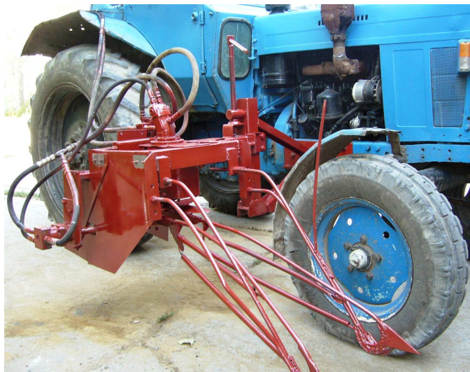
Рис. 8. Пристрій для чеканки виноградної шкілки.
