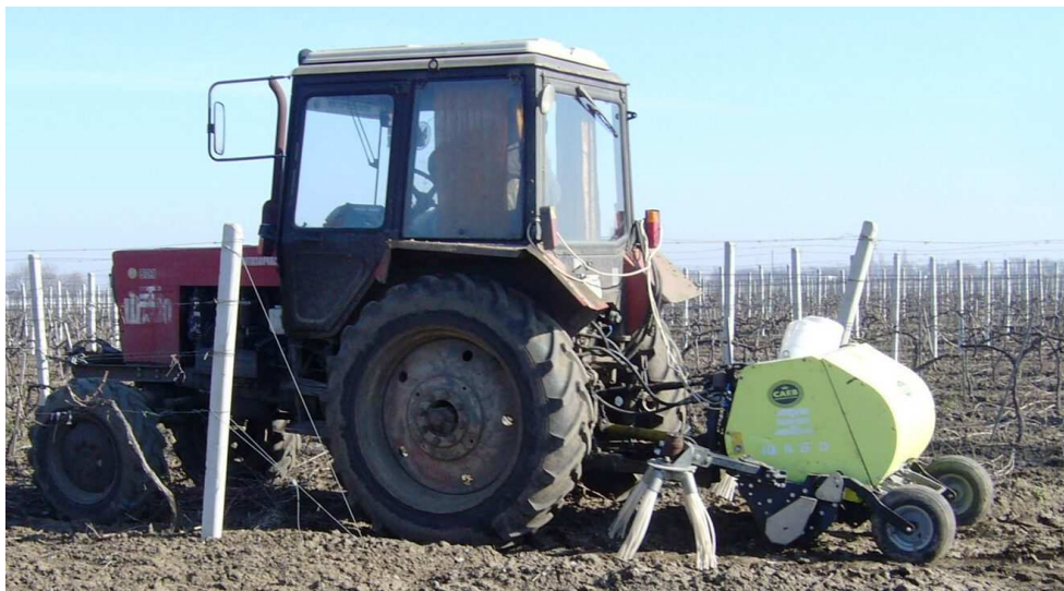
Рис. 10. Машина для підбирання зрізаної виноградної лози і утворення рулонів.
