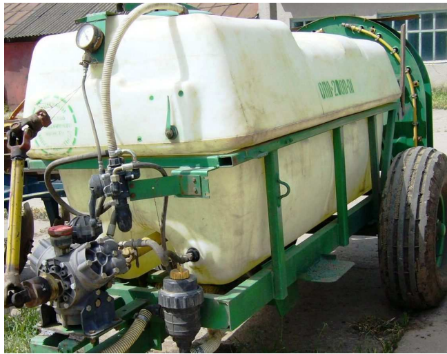
Рис. 7. Обприскувач виноградниковий з імпорнтним обладнанням.
