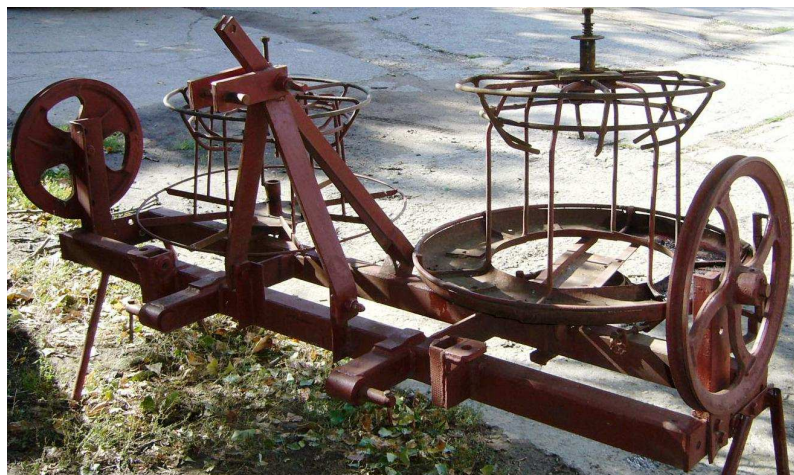
Рис. 9. Пристрій для розмотування шпалерного дроту.
