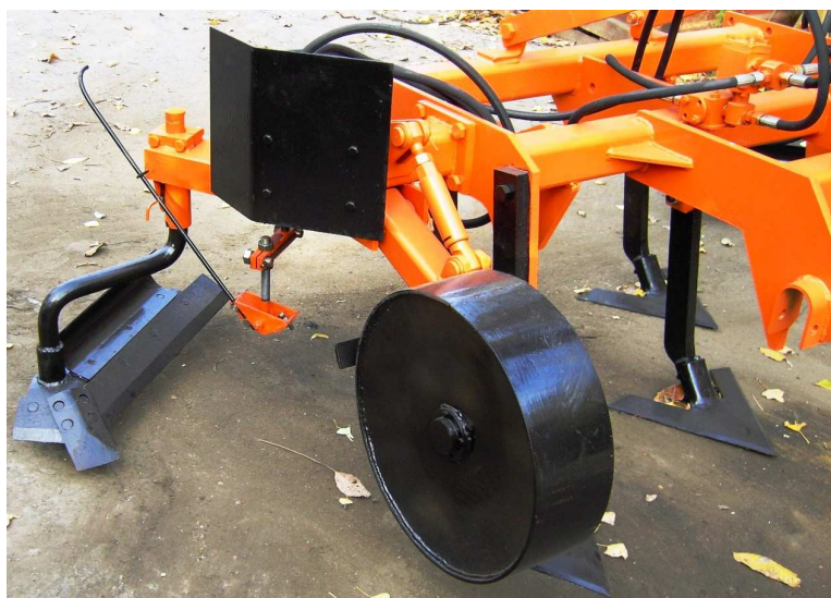
Рис. 4. Малоенергоємний відорюючий робочий орган.
