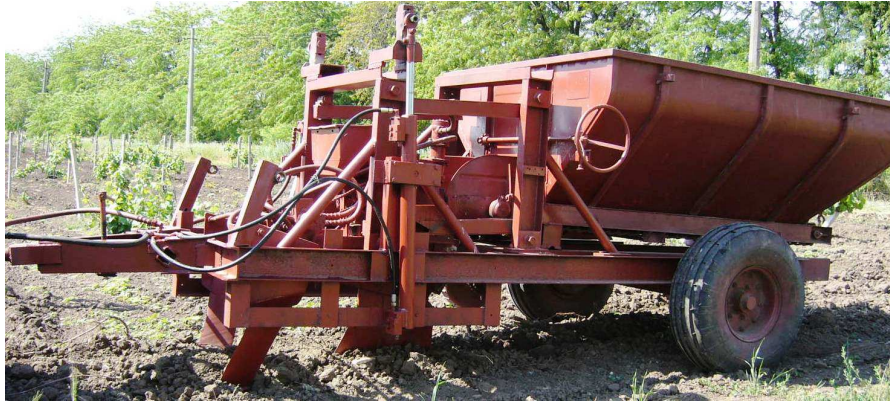
Рис. 2. Знаряддя для локального розпушення ґрунту і внесення добрив.
